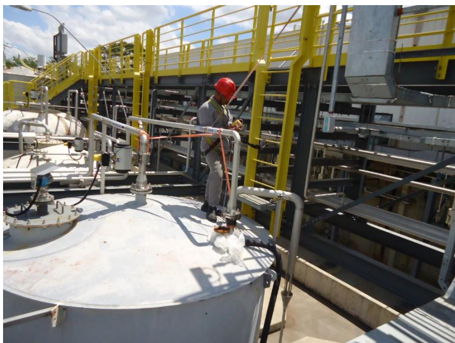
Figura 23 - Medições da atmosfera interna do tanque de Óleo de Soja.
