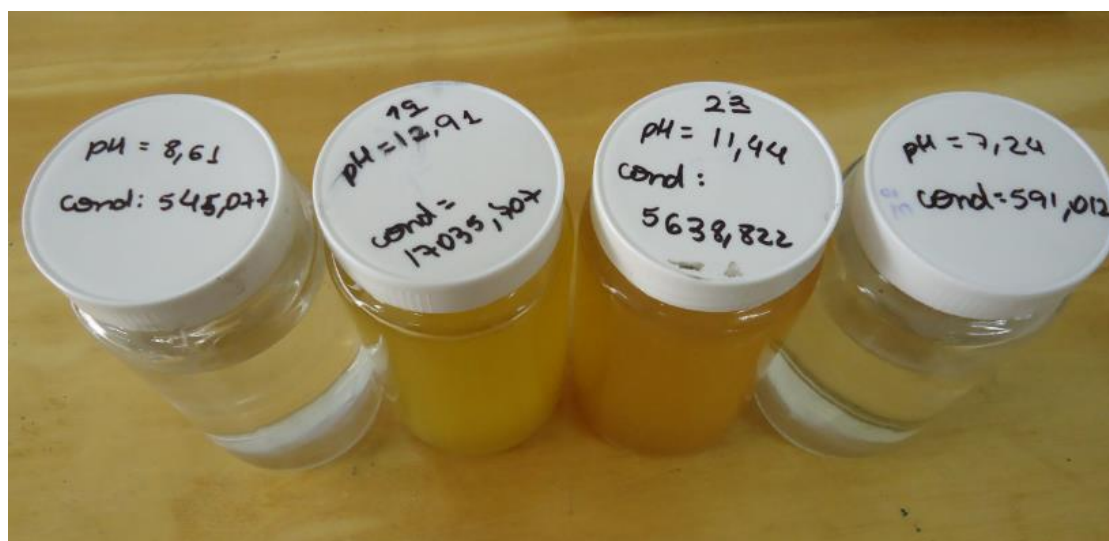
Figura 30 - Amostras das águas de entrada e residuais da lavagem do Tanque de Ácido Fórmico.
