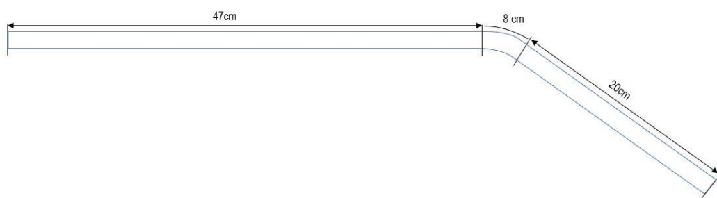
Figura 29 - Esquema de dobramento do tubo. Elaborada pelo autor.
