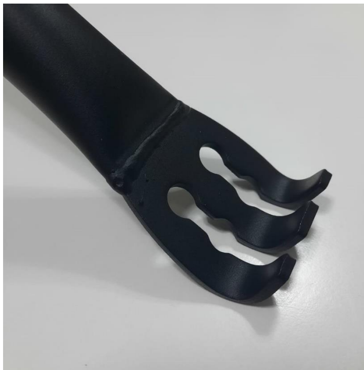
Figura 18 - Evidência de solda na junção da ponta com a extremidade do tubo. Foto tirada pelo autor.
