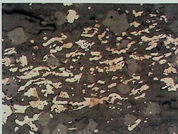
FotoS P - IV (SR-vt-01) Fotomicrografia de grafita-muscovita-quartzo xisto com cristais de pirrotita de forma granular alotrimorficos associado a algumas poucas piritas e um cristal de calcopirita. Aumento de 4x e Intensidade de luz 6, por método reflexivo.
