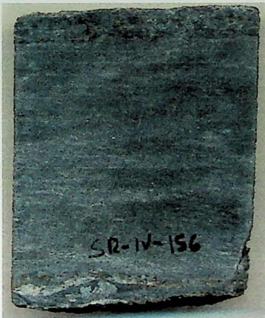
Fotos Pa - III - Testemunho de sondagem, utilizado para a descrição petrográfica, onde observamos uma foliação bem marcada, com concentração de sulfetos e grafita em camadas preferenciais, junto à foliação.
