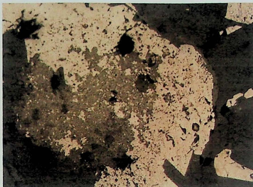
FotoS P - I (SR-IV-156) Fotomicrografia de grafita-muscovita-quartzo xisto com cristais de Pirrotita com inclusões de cristais de calcopirita e uma área alterada a esquerda da fotografia . Aumento de 8x e Intensidade de luz 10, por método reflexivo.
