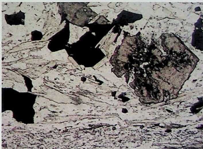
Foto P - xiv (SR-vt-01-I) Fotomicrografia de grafita-muscovita-quartzo xisto rico em quartzo, com uma granada rotacionada, de gênese anterior a xistosidade principal da rocha. Esta porção tem uma textura característica da porção granoblástica. Nicóis polarizados a esquerda e nicóis paralelos a direita ambas com aumento de 4x.
