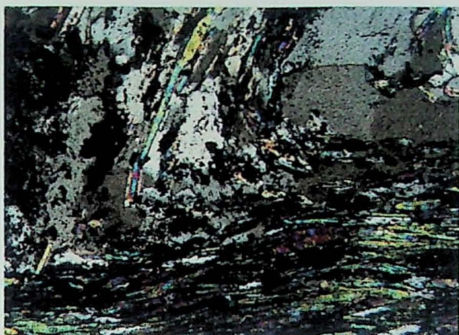
Foto P – xiii (SR-vt-01-ii) Idem ao anterior em um aumento de 20x. Nicóis polarizados a esquerda e paralelos a direita, que mostra claramente que a formação dos opacos é anterior ao evento Sn+1, a foliação principal da rocha.
