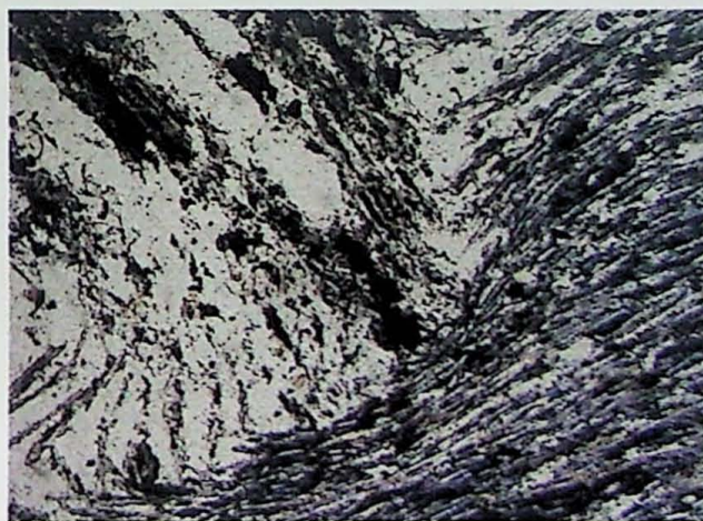
Foto P – xiv (SR-vt-01-ii) Fotomicrografia de biotita - grafita- granada- muscovita- quartzo xisto. Com grande concentração de micas e opacos (sulfetos e grafita principalmente), mostrando um dobramento bem pronunciado lepidogranoblástica com grandes cristais de quartzo . Nicóis polarizados a esquerda e paralelos a direita ambas com aumento de 10x.
