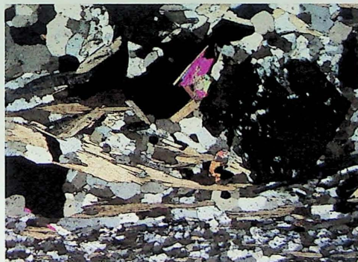
Foto P - xiv (SR-vt-01-I) Fotomicrografia de grafita-muscovita-quartzo xisto rico em quartzo, com uma granada rotacionada, de gênese anterior a xistosidade principal da rocha. Esta porção tem uma textura característica da porção granoblástica. Nicóis polarizados a esquerda e nicóis paralelos a direita ambas com aumento de 4x.
