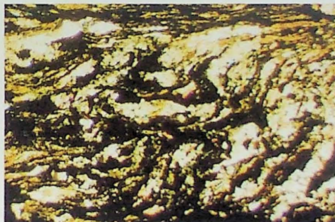
Foto P - II - Fotomicrografia de grafita-muscovita-quartzo xisto rico em sulfetos (amostra SR-106 - 37,50m) apresentando aspectos estruturais (clivagem de crenulação) e texturais desenhados por quartzo (material branco), muscovita e clorita (filetes e agregados orientados levemente coloridos) e os minerais opacos (material preto). Nicóls paralelos a esquerda e nicóls cruzados a direita, ambas com aumento de 40 vezes.
