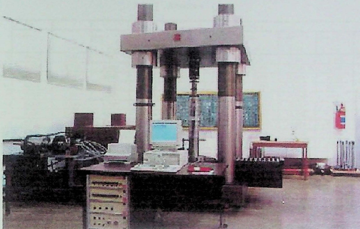
Figura EG 5 – Sistema servo-controlado para realizações de ensaios de compressão uniaxial.
