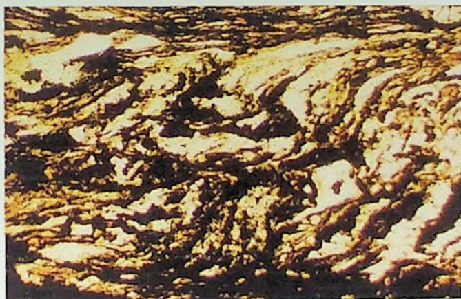
Foto P - II - Fotomicrografia de grafita-muscovita-quartzo xisto rico em sulfetos (amostra SR-106 - 37,50m) apresentando aspectos estruturais (clivagem de crenulação) e texturais desenhados por quartzo (material branco), muscovita e clorita (filetes e agregados orientados levemente coloridos) e os minerais opacos (material preto). Nicóls paralelos a esquerda e nicóls cruzados a direita, ambas com aumento de 40 vezes.
