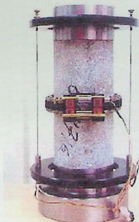
Figura EG 6 – Montagem do corpo de prova para a realização do ensaio de compressão uniaxial.
