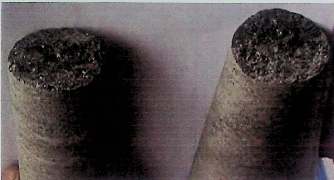
Foto Pa - I – fotografia do testemunho de sondagem de um grafita-muscovita-quartzo xisto rico grafita da sondagem SM –128 respectivamente a 54 e 55,5 metros de profundidade, plano de cisalhamento, junto a concentração de grafita.
