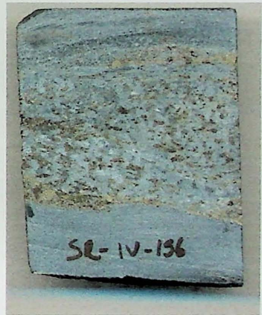
Fotos Pa - III - Testemunho de sondagem, utilizado para a descrição petrográfica, onde observamos uma foliação bem marcada, com concentração de sulfetos e grafita em camadas preferenciais, junto à foliação.
