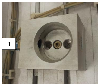
Figura 13 - área de trabalho; 1-válvula a vácuo
