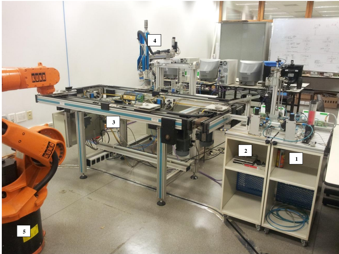
Figura 4 -Visão geral do sistema, com todos os seus componentes. São eles: 1- Distribuição; 2- Teste; 3- Transporte; 4- Montagem; 5- Braço robô
