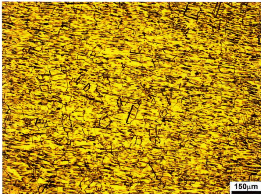
Figura 5.1.3 (a) - Micrografias do ensaio de sensitização no Metal de Base aumento 100 vezes [CTMSP, 2015].
