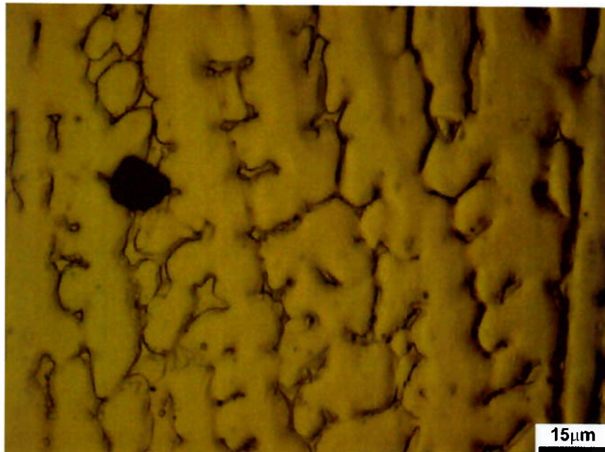
Figura 5.1.1 (c) - Micrografias do ensaio de sensitização na Zona Fundida; aumento de 1000 vezes [CTMSP, 2015].
