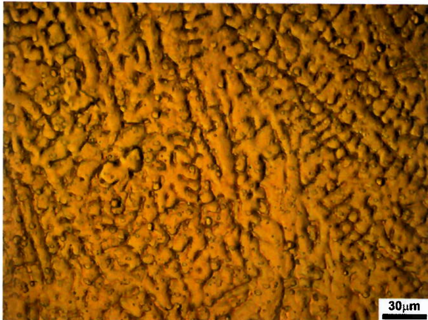
Figura 5.1.1 (b) - Micrografias do ensaio de sensitização na Zona Fundida; aumento de 500 vezes [CTMSP, 2015].
