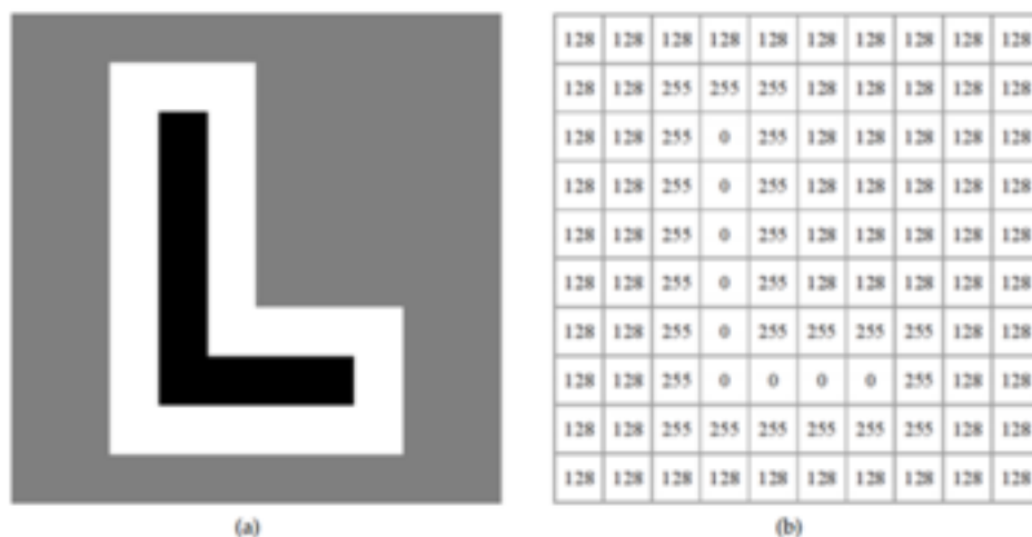
Figura 1 – Imagem digital. (a) Exemplo de uma imagem digital. (b) Representação matricial correspondente.
