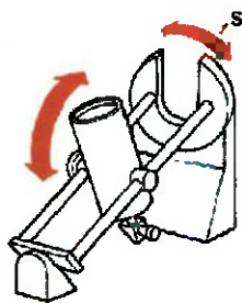
Figura 31 - Esquema da montagem tipo Berço
