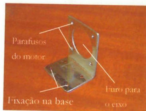
Figura 69 - Suporte para os motores de passo - medidas de acordo com o motor usado
