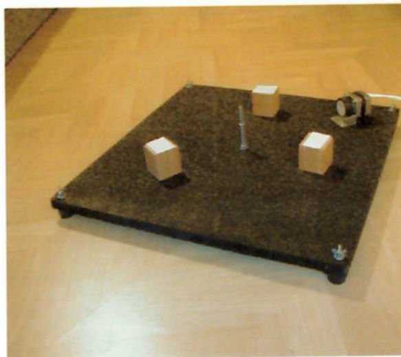
Figura 53 - Base com apoios e motor
