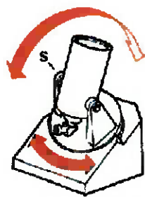
Figura 29 - Esquema da montagem tipo Forquilha
