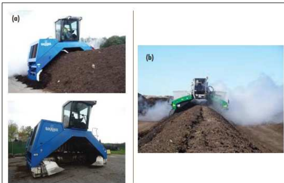
Figura 3 – Método natural de aeração que utiliza reviramento mecânico das leiras. (a) Unidade de compostagem de Montgomery e (b) detalhamento do equipamento utilizado.
