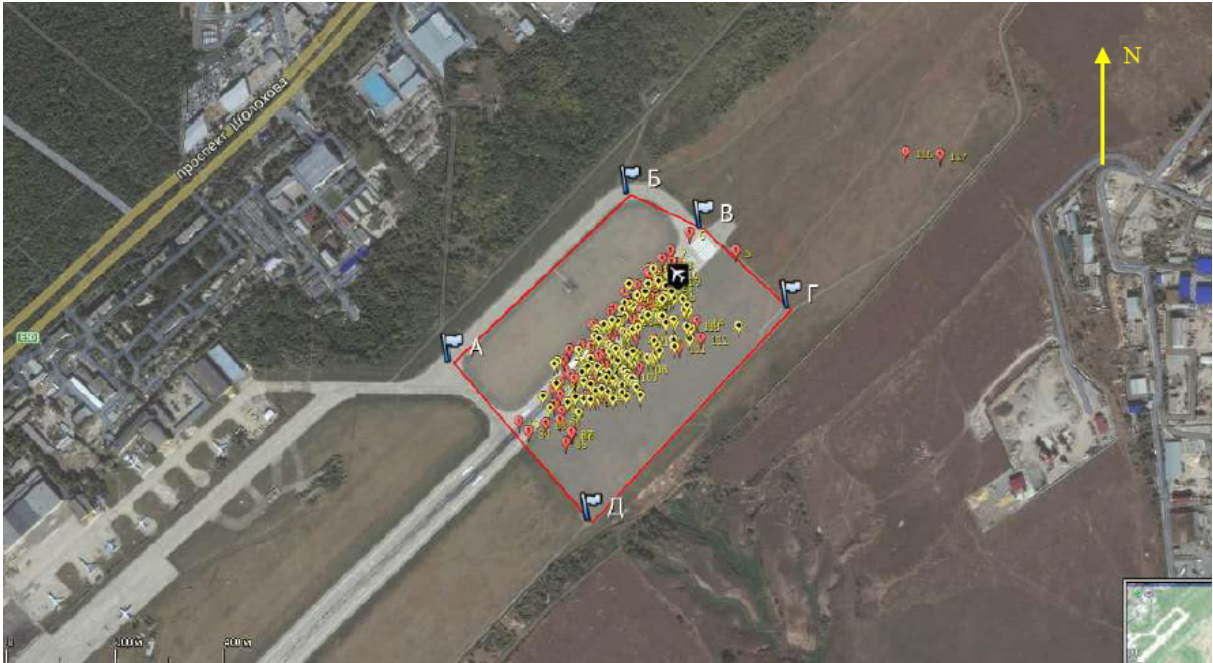
Figura 13: Local de impacto e disposição dos destroços da aeronave.
