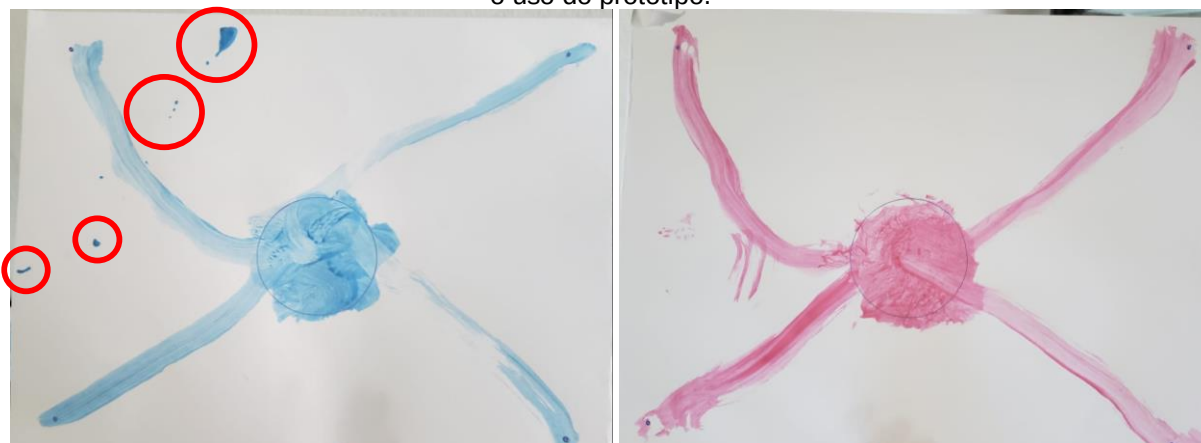
Figura 29 - (a) Respingos de tinta ao utilizar o pincel convencional; (b) Sem respingos de tinta durante o uso do protótipo.
