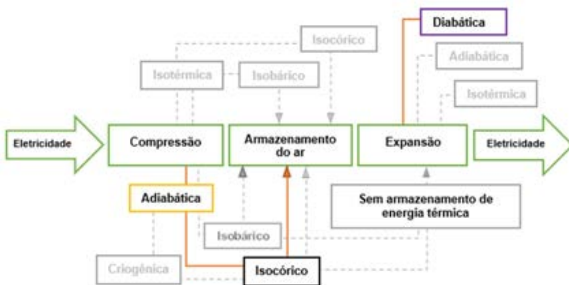
Figura 4.4: Diagrama dos processos empregados na compressão, armazenamento e expansão da usina de McIntosh . Adaptado de: Carlos Roberto Rocha, Marco Aurélio Guimarães Monteiro (2014); Filipa Vaz Ramires Gomes da Costa (2019).
