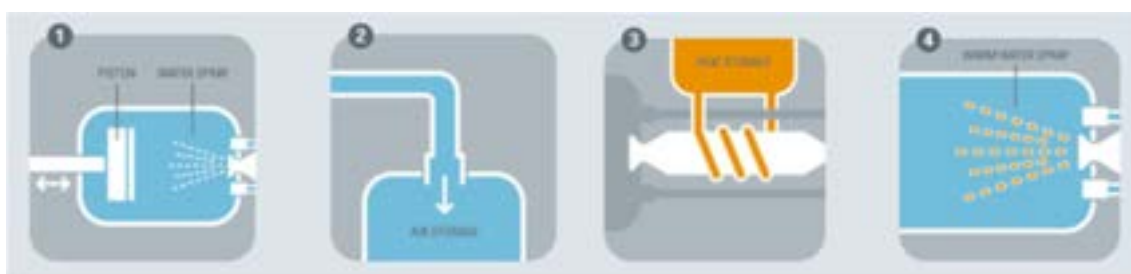
Figura 5.9: Compressão e expansão de ar comprimido quase isotérmica usando injeção direta de spray de água da LightSail . Fonte: Danielle Fong (2022)
