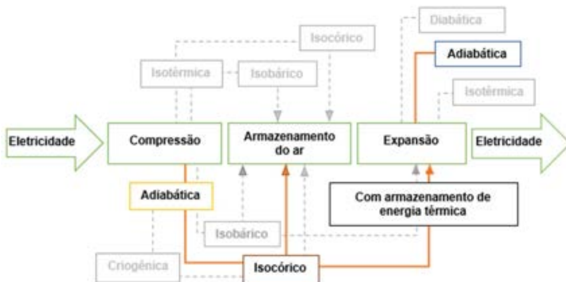
Figura 4.6: Diagrama dos processos empregados na compressão, armazenamento e expansão de um sistema adiabático avançado de armazenamento de energia com ar comprimido.
