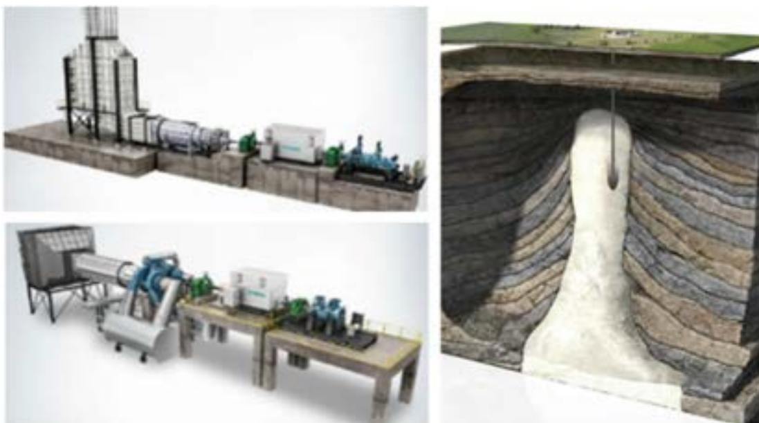
Figura 5.14: Vista da turbina, compressor e caverna salina. Fonte: Apex CAES (2022)
