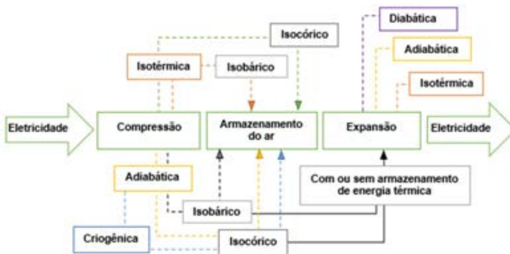
Figura 4.2: Diagrama com as diferentes tecnologias dos processos empregados na compressão, armazenamento e expansão. Adaptado de: Carlos Roberto Rocha, Marco Aurélio Guimarães Monteiro (2014); Filipa Vaz Ramires Gomes da Costa (2019).
