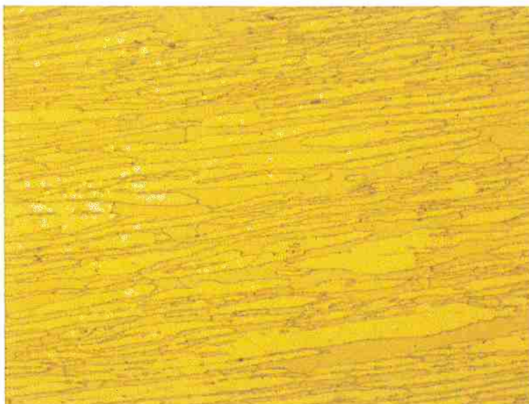
Figura 5.10: Microestrutura correspondente ao corpo de prova 07 (apenas solubilizado). Ampliação: 200X. Ataque: KOH 10%. A região clara é a austenita, enquanto que a região escura é a ferrita.
