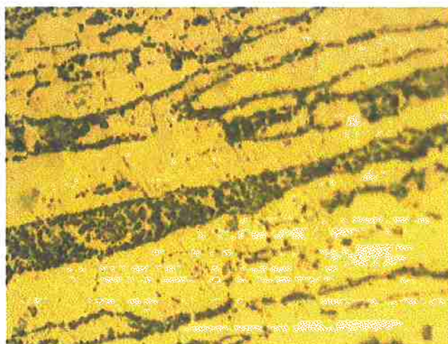
Figura 5.3: Microestrutura correspondente ao corpo de prova 01(750°C/7,5h). Ampliação: 500X. Ataque: KOH 10%. A fase sigma é a região escura, enquanto que o fundo claro diz respeito à austenita.
