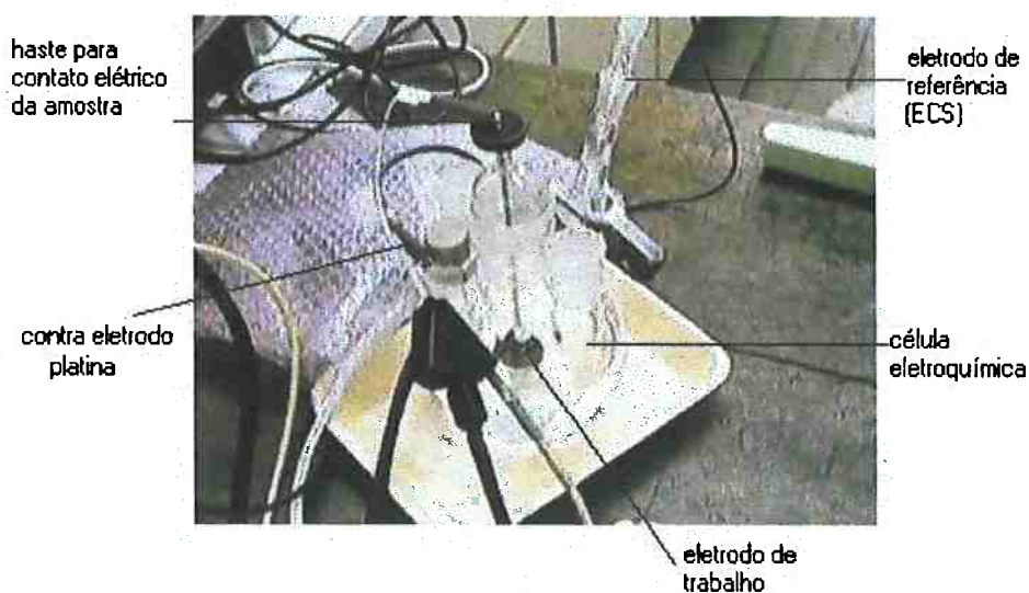
Figura 4.2: Montagem e funcionamento da célula eletroquímica.
