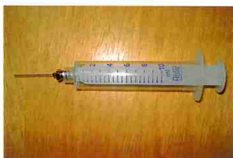
Figura 6. Seringa e ponteira usadas na eletrofiação.
