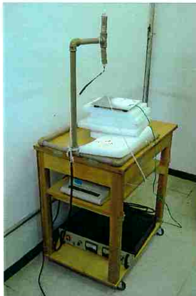
Figura 7. Aparato experimental da técnica de eletrofiação.
