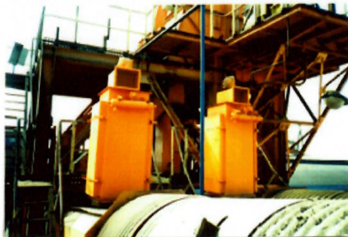
Figura 14 - Filtros pontuais compactos Fonte: Disponível em: www.safetyguard.com.br
