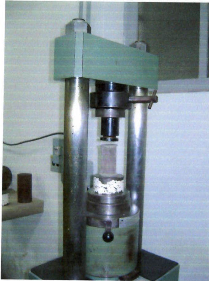
Figura 9 – Corpo de prova prestes a ser ensaiado no teste de compressão uniaxial, em prensa hidráulica
