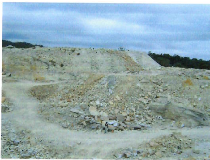
Figura 1 – Uma das pilhas de rejeito da lavra do empreendimento.
