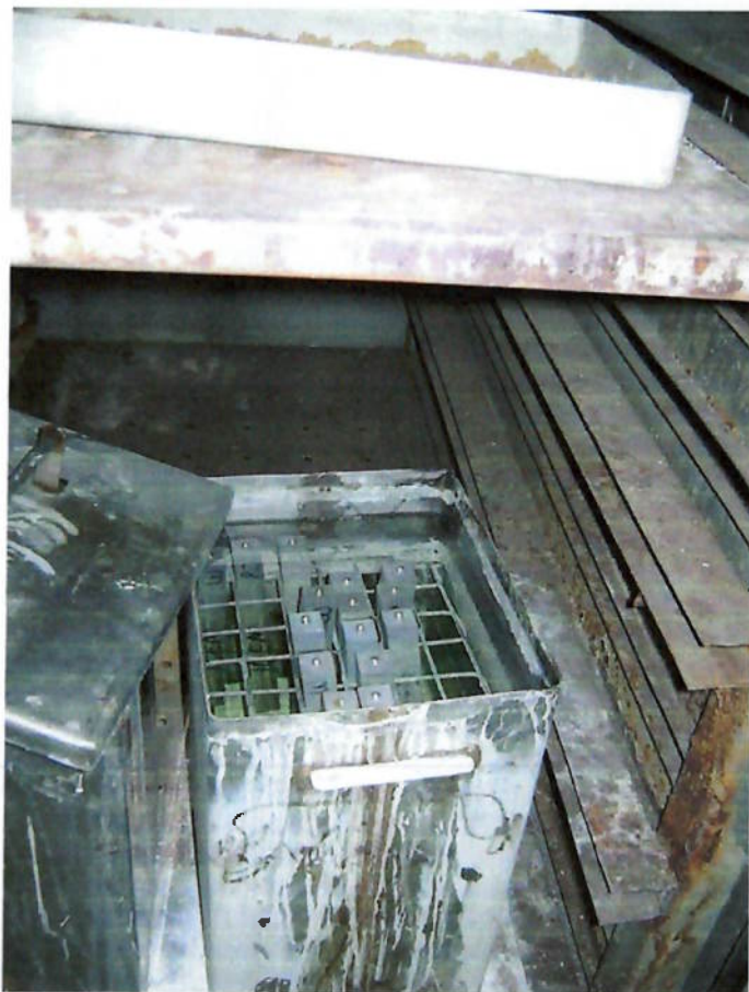
Figura 5 - Barras do ensaio de reatividade imersas em solução de hidróxido de sódio.
