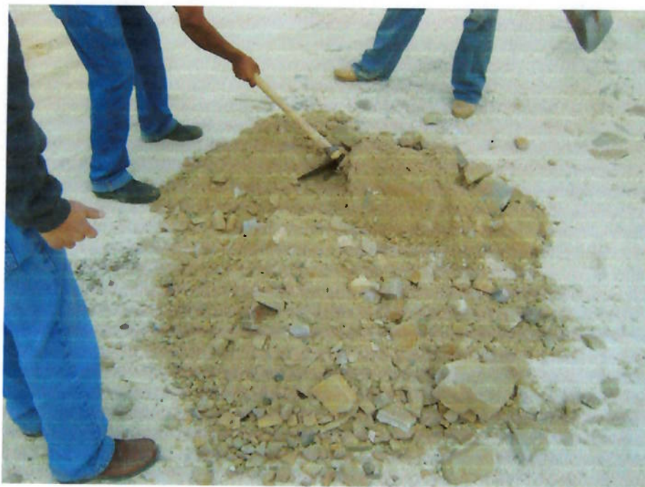
Figura 2 - Pilha cônica feita no empreendimento para amostragem de material.
