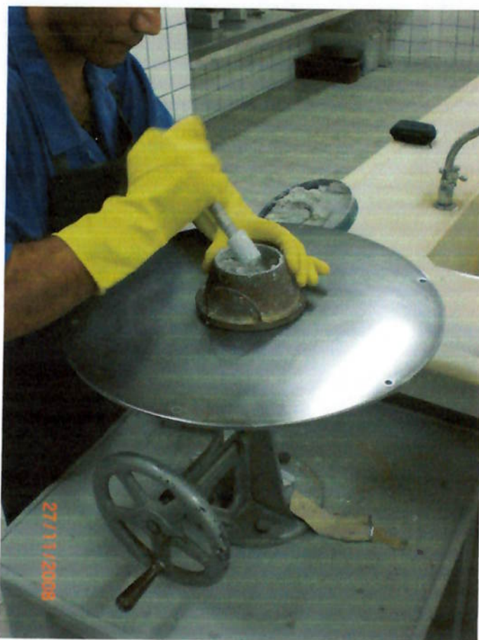
Figura 7 – Preparação para ensaio de consistência de argamassa
