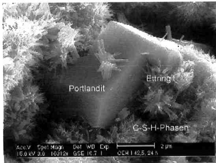
Figura 5 - Micrografia eletrônica de varredura de uma pasta de Cimento Portland. Fases presentes: Ettringita, C-S-H e Portlandita (Hidróxido de cálcio cristalino) (LABOR DER BAUHAUS-UNIVERSITÄT WEIMAR, 2004).
