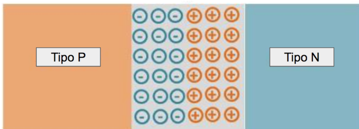
Figura 8 – Zona de depleção formando campo elétrico no semicondutor.
