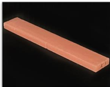
Figura 3 - Corpo de prova retangular da resina SmartPrint
